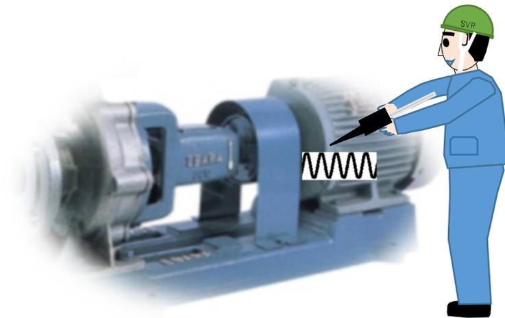
振動の計測は物が破損や機能劣化を生じた場合、あるいは物の耐振動性を確かめるなどの場合に行うことはシリーズ2で理解できました。また、具体的には振動している物の①振動数、②固有振動数、③、振幅、④減衰比、⑤振動モードを計測する必要があることも理解できました。ところで振動はどのように計測し、どのような分析をするのでしょうか？
